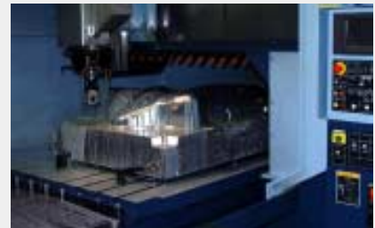
【図8】FX-10GWによる高速加工(温度管理の意味でもクーラントの使用は重要)
