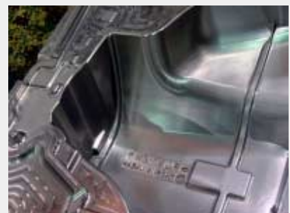
【図10】コーナー部分の拡大(等高線ツールパスによる高精度切削，手仕上げは行わない，CAMシステムはmsg)
