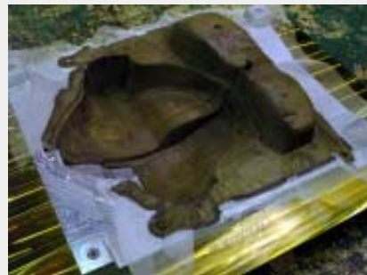
【図11】図9の金型で成形される発泡ウレタン製インシュレータ
