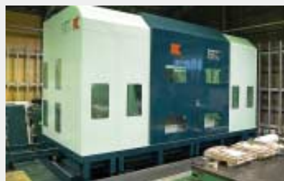
【図12】マシニングセンタKBH-18（倉敷機械製，加工範囲：2.0 × 3.0m，主軸最高回転数：12,000rpm）
