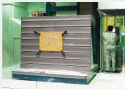
【図14】KBH-18インデックステーブル（1万分の1deg精度での角度割り出し＋5軸切削用のC軸追加が可能な特注品）
