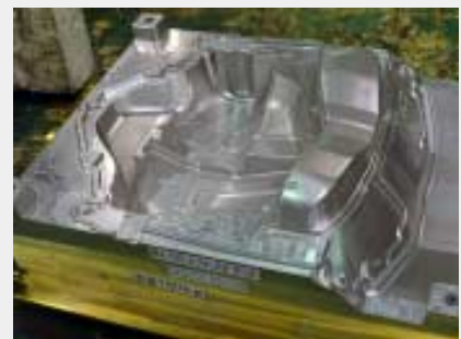
【図9】FX-10GWによるアルミ金型の加工例
