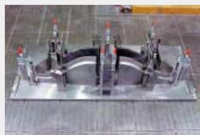
【図5】プレス部品(サスペンションメンバー)向け総スチール製高精度検具
